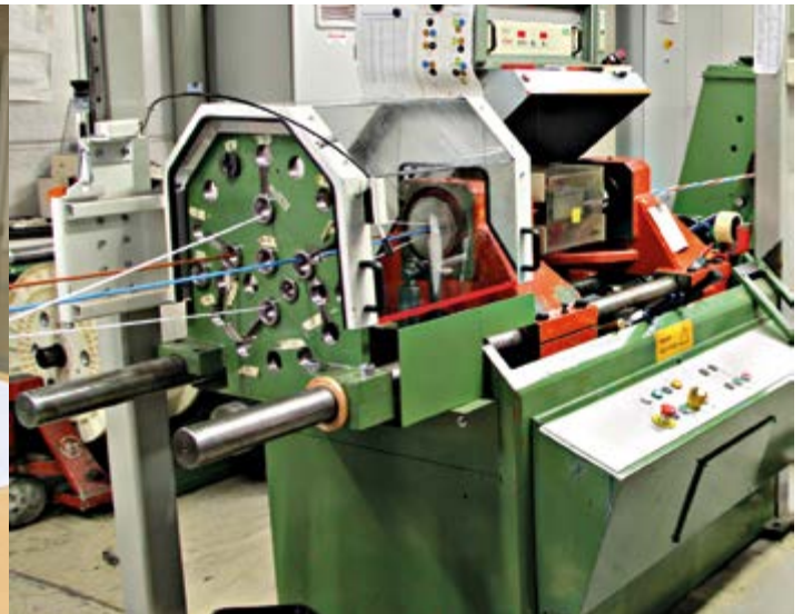
Kaapelointikoneella valmistetaan vuosittain 100–200 erilaista kaapelia. Modernisoinnin ansiosta tuotteen vaihto linjalla on entistä yksinkertaisempaa ja nopeampaa.
